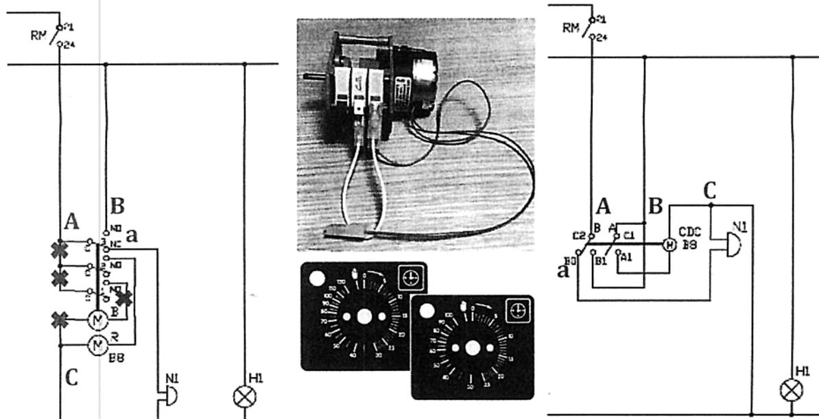
Una volta realizzati i collegamenti elettrici fissare il timer al pannello e, poiché il movimento del nuovo timer non ha corrispondenza con il precedente, applicare la scala adesiva del timer adatta al tipo di alimentazione (50 o 60 Hz) sul pannello comandi.
